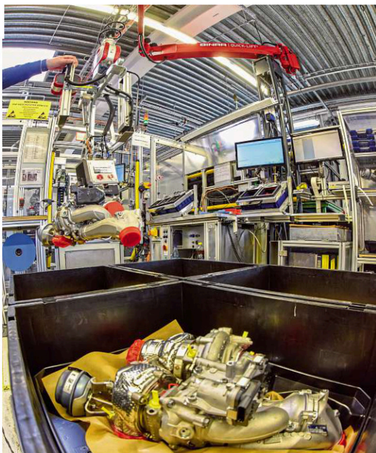
Con una grúa, el operario coloca los turbocompresores en las bandejas de las cuatro cajas después de la última estación de montaje. En cada paleta se apilan tres capas de cajas.
