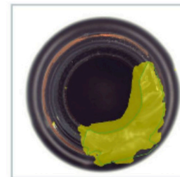
Figura | La detección de anomalías HALCON con autoaprendizaje reconoce defectos en el cuello de la botella. © Cretec / MVTEC
