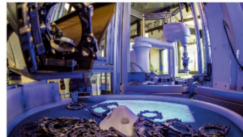
Figura 1 | Las piezas caen desde el alimentador al disco vibratorio del QBIC FlexiBowl. Se separan de forma fiable, la visión las localiza y el robot las agarra con precisión para presentarlas al segundo sistema de visión 2D y 3D. © Cretec GmbH
