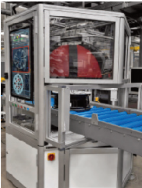
Integrado en la cinta transportadora, QBIC Wheels realiza el control de calidad final de las llantas con un tiempo de ciclo inferior a 6,2 s.
