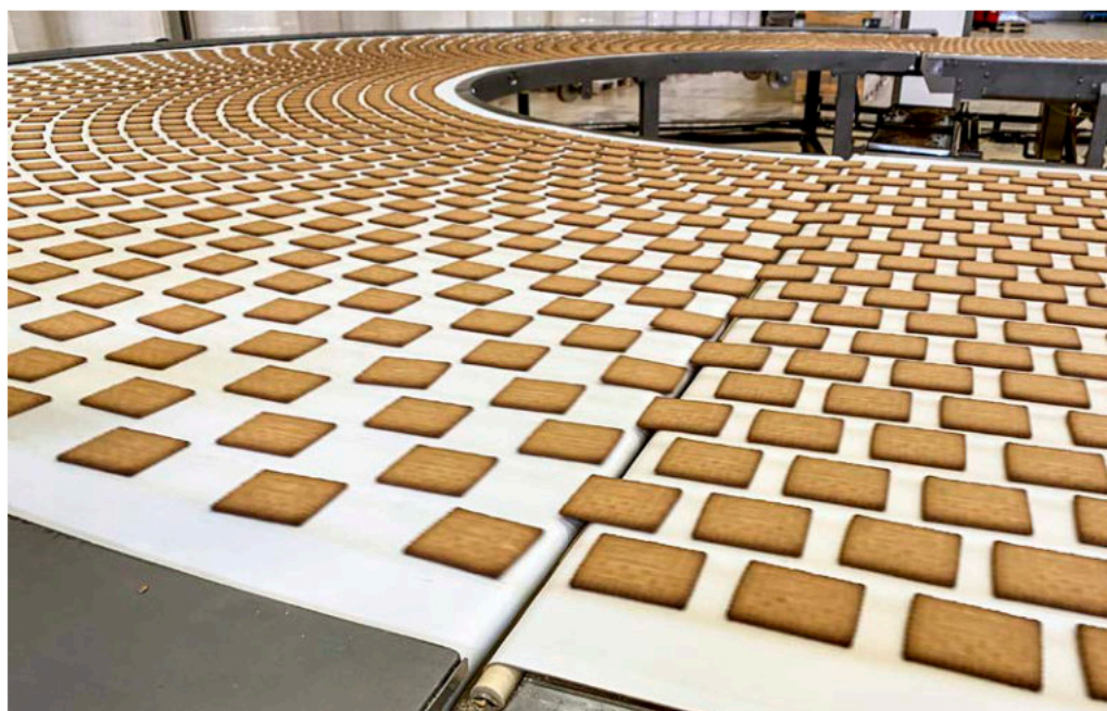
Figure 2 | 4 200 biscuits par minute doivent être contrôlés très précisément selon de nombreux critères et classés conformes ou non conformes.
