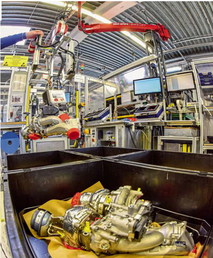
À l'aide d'une grue, l'opérateur place les turbocompresseurs dans les plateaux des quatre cartons après la dernière station d'assemblage. Trois couches de cartons sont empilées sur chaque palette.
