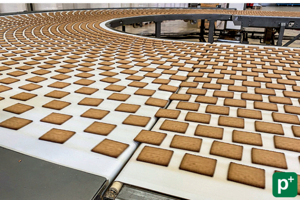
4 200 biscuits par minute sont contrôlés très précisément selon de nombreux critères et triés en conformes et non conformes. Photo : Cretec.
