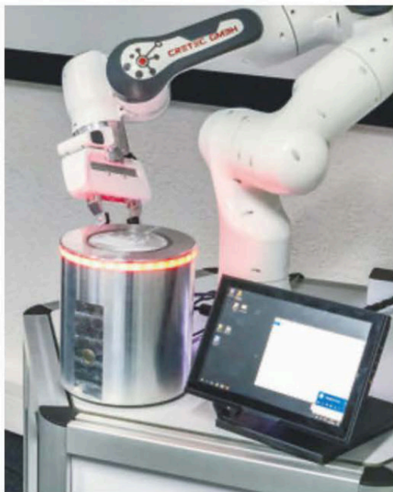
La vérification précise valide les données selon les normes internationales usuelles pour codes 1D (ISO 15416) et 2D (ISO 15415, ISO 29158, AIM/DPM). © Cretec
