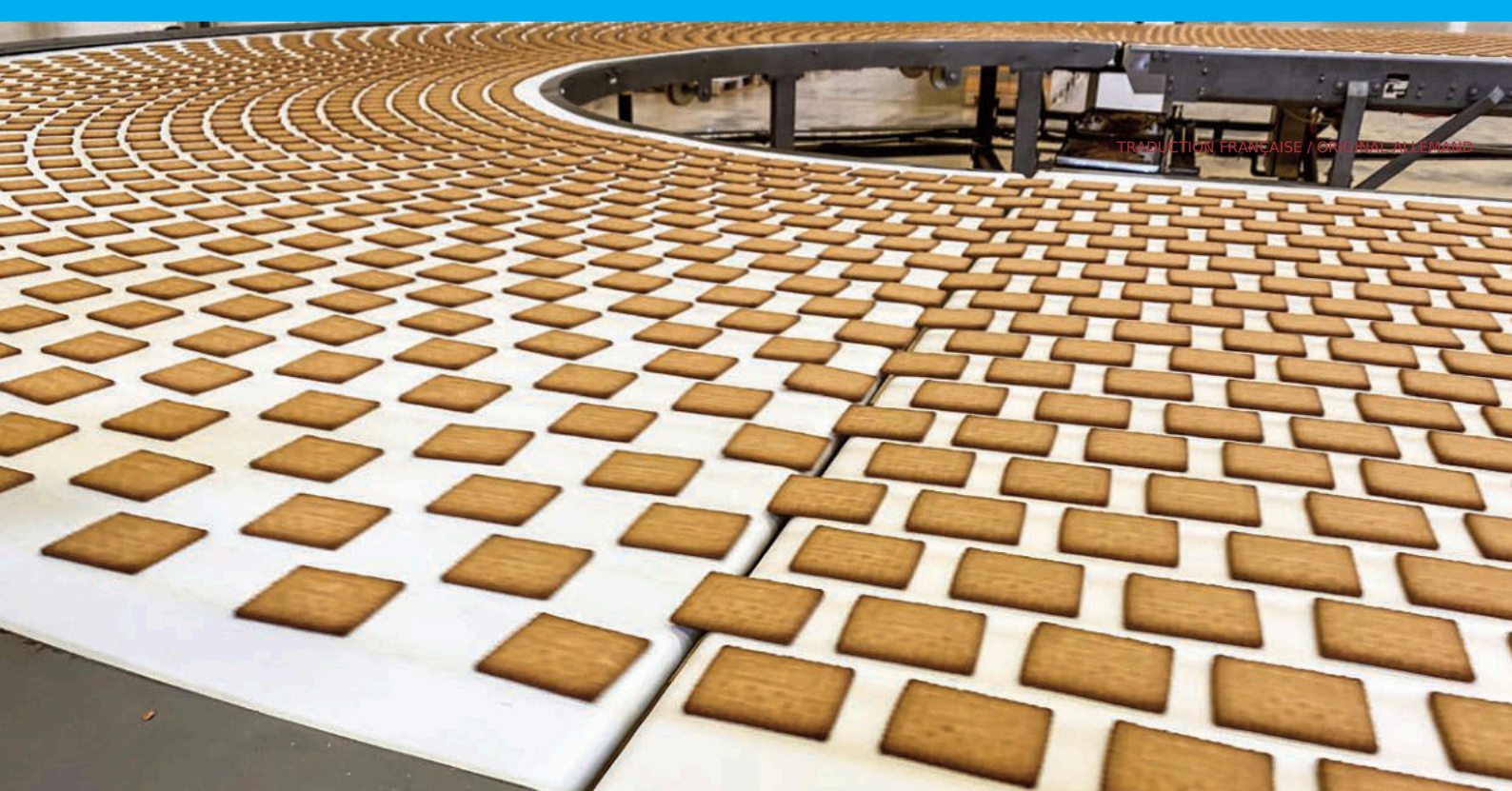
Figure 1 | Pendant la production, 4 200 biscuits par minute sont contrôlés précisément selon plus de 20 critères et triés en conformes et non conformes. De nombreux résultats sont utilisés directement comme flux de données en retour vers le processus.
