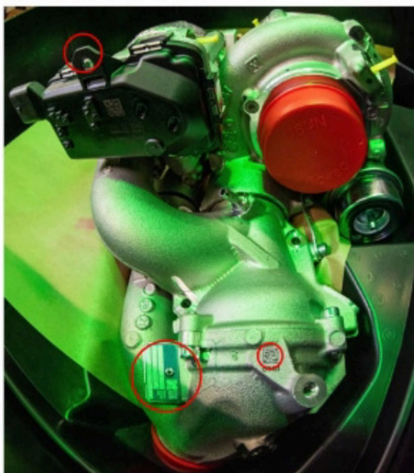
Trois des douze critères : une nervure plastique de 3 mm, la plaque signalétique et le code DataMatrix d'environ 5 mm × 5 mm.
