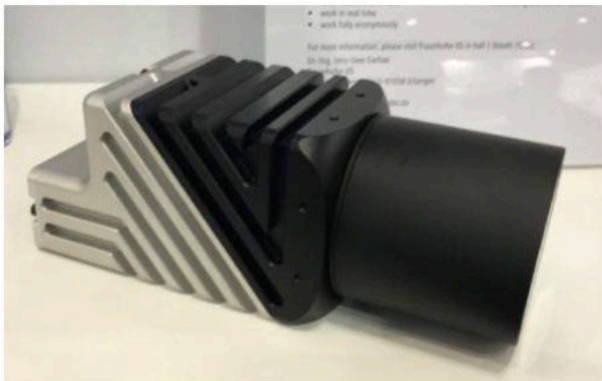
Fig. 3 : La caméra AX de Baumer, fondée sur une plateforme Linux open source, intègre un GPU NVIDIA performant (Jetson TK1/TX2).
