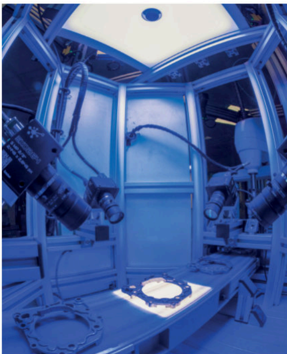
03 | Cinq caméras haute résolution contrôlent simultanément de nombreux critères en un temps très court, en éclairage incident et transmis, sur le convoyeur en mouvement.
