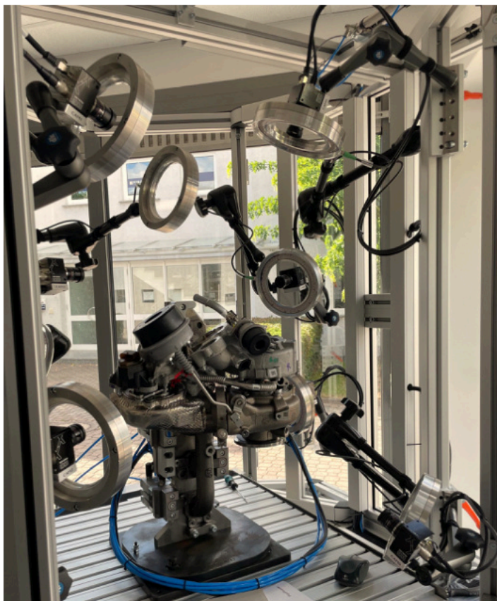
Les huit caméras de 5 MP et leurs champs de vision haute résolution permettent un contrôle 3D complet des ensembles de turbocompresseurs sous tous les angles. (Image : Cretec)
