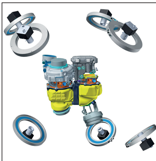
03 Les huit caméras de 5 MP sont positionnées de sorte que leurs champs de vision à haute résolution permettent un contrôle 3D complet des ensembles de turbocompresseurs, sous tous les angles.
