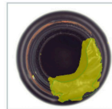
Figure | La détection d'anomalies HALCON avec autoapprentissage détecte les défauts du col de la bouteille. © Cretec / MVtec
