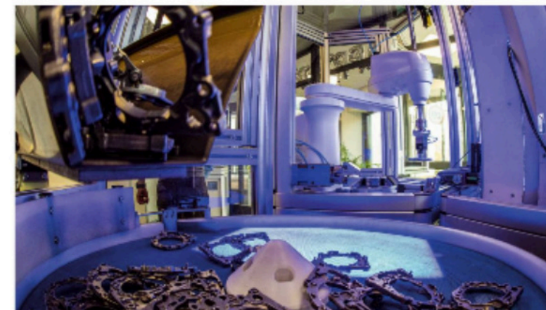
Figure 1 | Les pièces tombent de l'alimentation sur le disque vibrant du QBIC FlexiBowl. Elles sont séparées de façon fiable, localisées par vision puis saisies précisément par le robot, qui les présente au deuxième système de vision 2D et 3D. © Cretec GmbH
