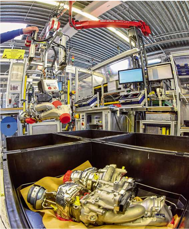
Mithilfe eines Krans werden die Turbolader nach der letzten Montagestation vom Werker auf die Trays der vier Boxen verteilt. Auf jeder Palette werden drei Boxenschichten gestapelt.
