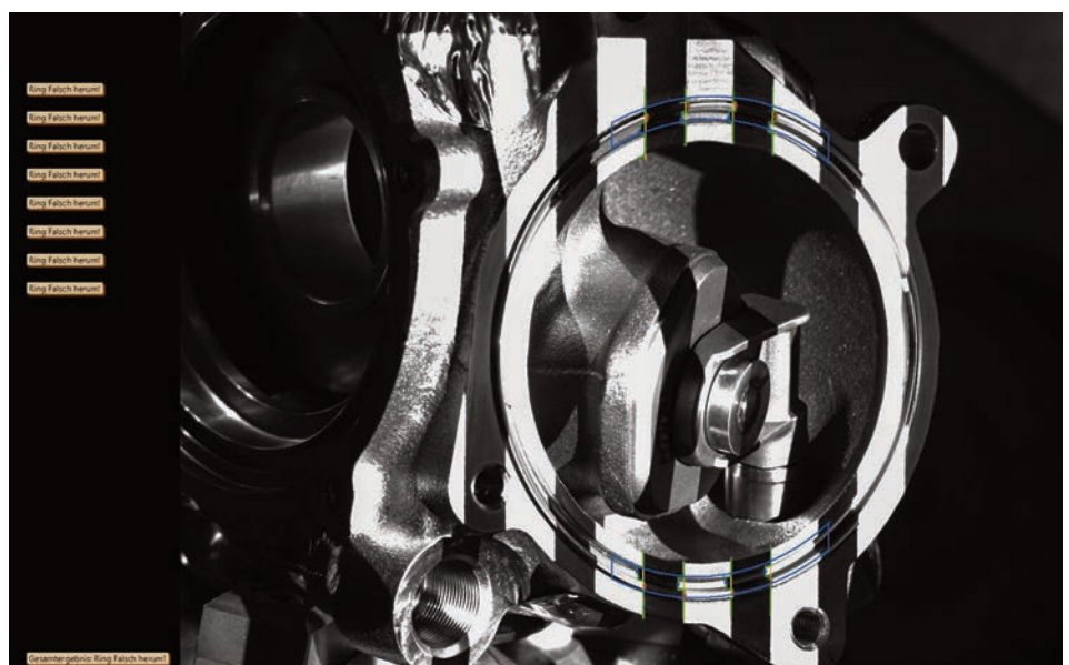
Z-Ring Kontrolle des Turboaggregats auf Anwesenheit und 3D-Höhe mittels eines LED-Projektors und einer 20MP-Zoomkamera.
