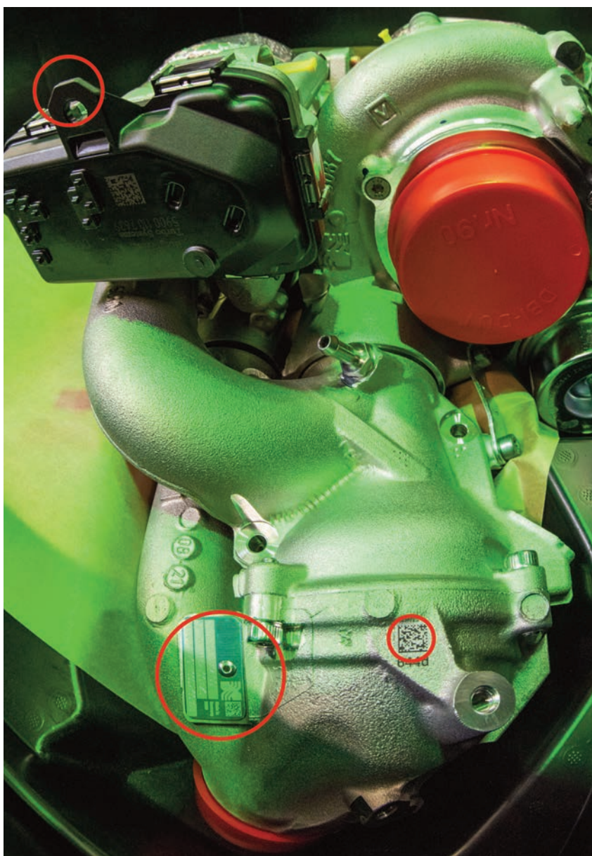
Prüfung aus 3,5m Höhe von zwölf Merkmalen eines Turboaggregats eines Automobilzulieferers. Rot eingekreist: die Detektion eines 3mm breiten Kunststoffsteges, das Typenschild des Aggregats sowie ein 5x5mm kleiner DM-Code.
