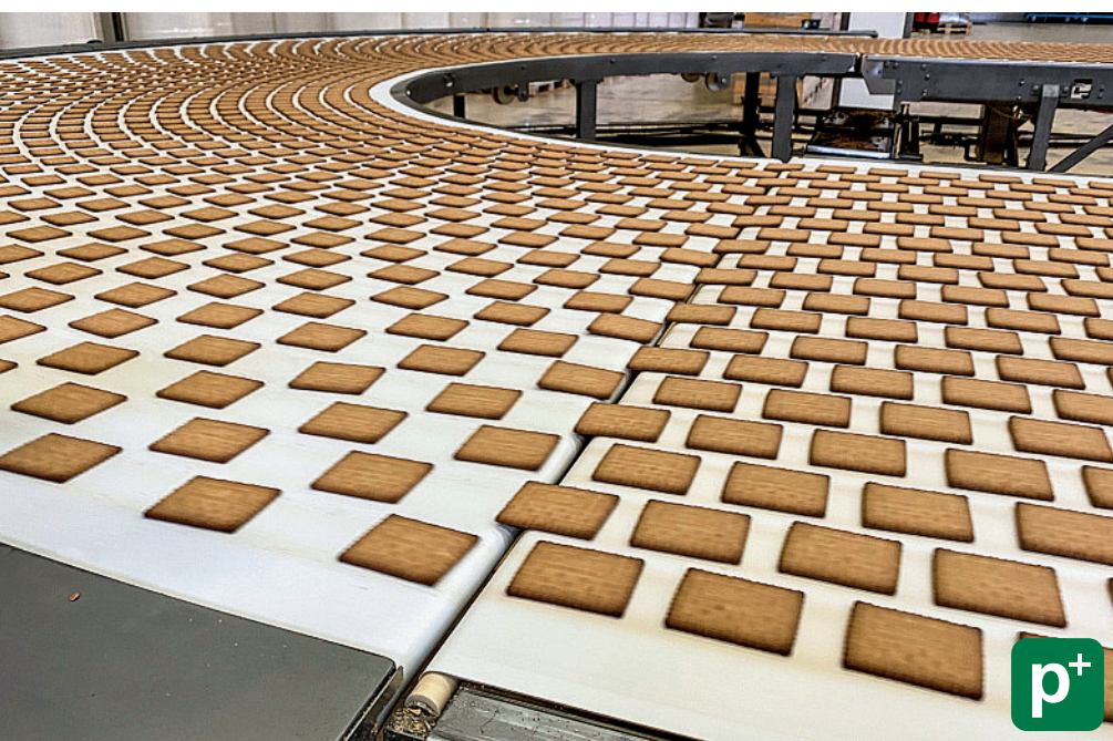
4200 Kekse pro Minute müssen in der hochwertigen Qualitätssicherung auf viele Merkmale sehr präzise detektiert und in IO/NIO getrennt werden. (Bild: Cretec)
