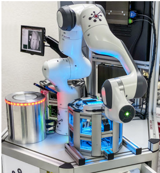
Das modulare QBIC-System mit Cobot kann - als universelle, sehr flexible Arbeitsplattform - viele ID-Prüf- und Verifikationsaufgaben sowie Qualitätsprüfungen mit Visionsystem auf minimalem Raum vollautomatisch erledigen.
