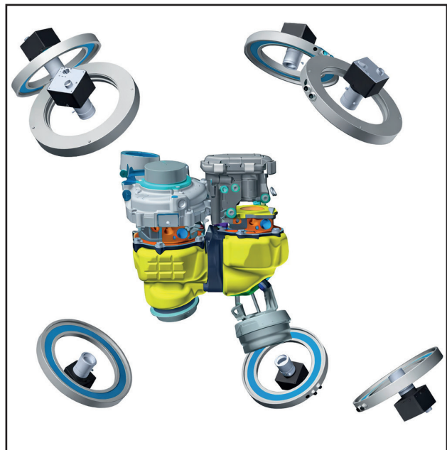
03 Die Positionierungen der insgesamt acht 5MP-Kameras liefern mit den einzelnen hochauflösenden Bildfeldern eine vollständige Rundum-3D-Kontrollmöglichkeit der Turboaggregate.
