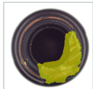
Bild 2: Die Anomalie-Detektion-Technologie in der BV-Software Halcon erkennt selbstlernend einen Fehler am Flaschenhals.
