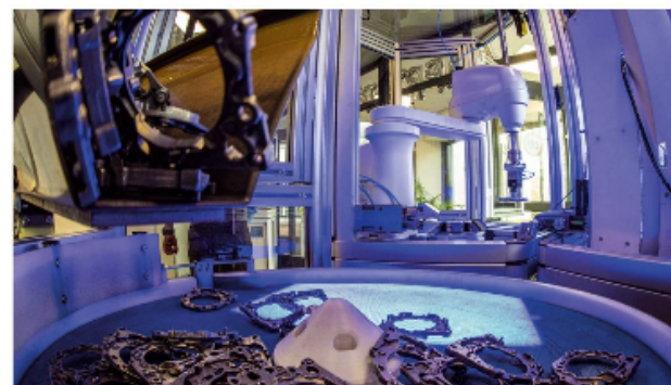
Bild 1: Vom Teileförderer fallen die Bauteile auf den Rütteltisch in der Station QBIC FlexiBowl. Hier werden sie zuverlässig vereinzelt, per Bildverarbeitung exakt lokalisiert, vom Roboter präzise erfasst und den weiteren 2D und 3D-Visionssystemen dargeboten. © Cretec GmbH
