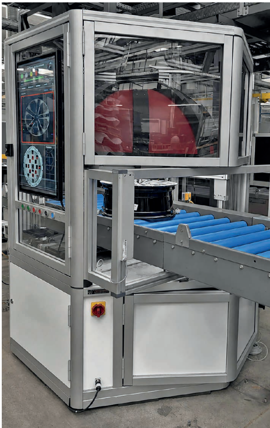
Das Inspektionssystem QUBIC Wheels prüft die Autofelgen in unter 6,2 Sekunden. Dies ermöglichen unter anderem die Kombination aus Dom-Beleuchtung mit 1.000 Durchmesser und die 17 Kameras.
